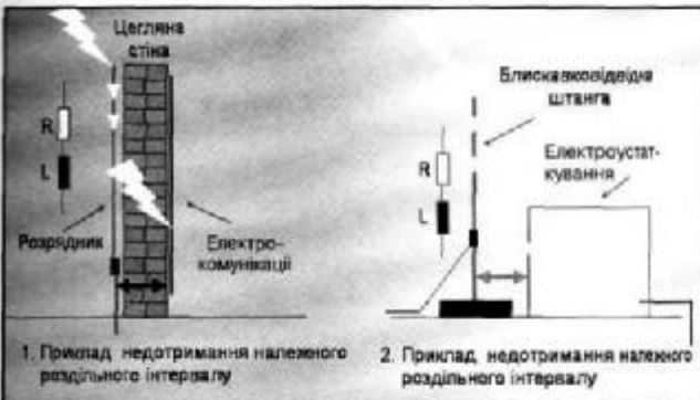
Рис.15. Ізольована система блискавкозахисту (на основі продукції фірми «OBO Bettermann GmbH & Co.»)
