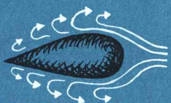
ДВИЖЕНИЕ В ВОДЕ ОБТЕКАЕМОГО ТЕЛА С ТВЕРДОЙ ОБОЛОЧКОЙ
