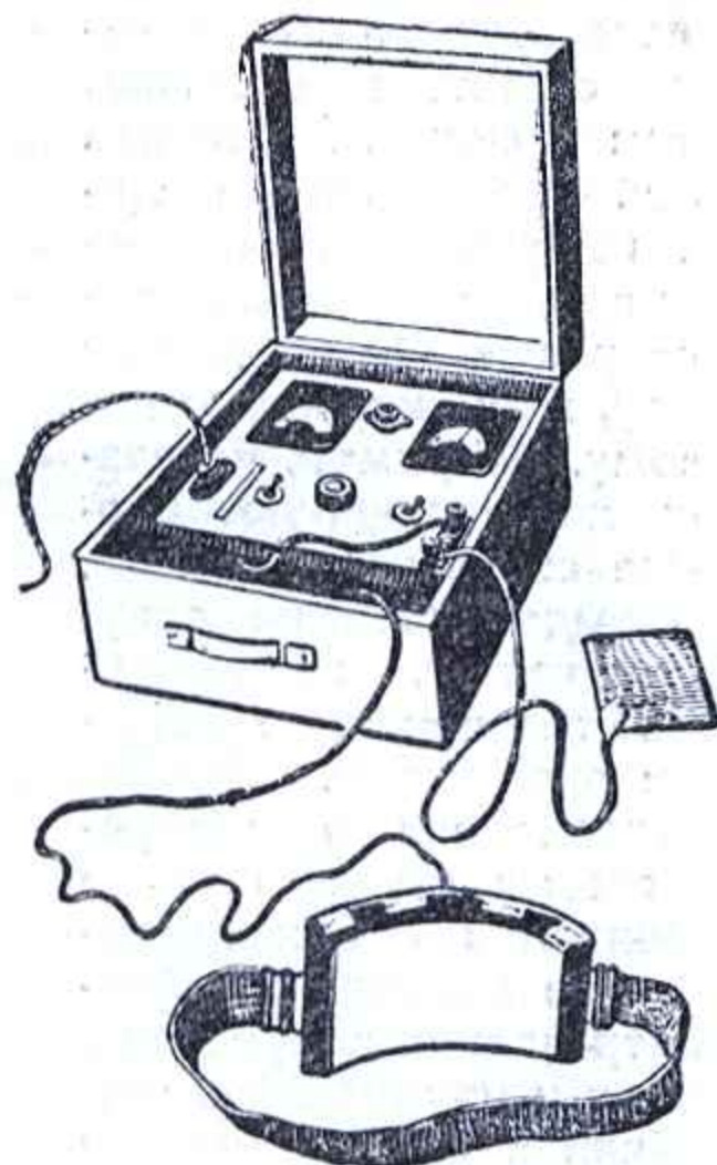
Внешний вид электрографа для исследования плоских предметов (слева) и выпуклых (справа).
